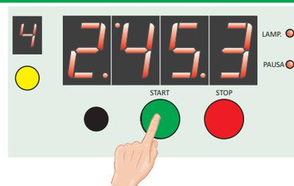
Durante il conto alla rovescia, il **LED rosso "LAMP"** è acceso e indica che la lampada dell'ingranditore è attivata. Inoltre la coppia di puntini separatori sul gruppo display (a sinistra) lampeggiano ad una frequenza di 1 Hz (puntini per i secondi) e il puntino separatore a destra lampeggia alla frequenza di 10 Hz (puntino per i decimi).
