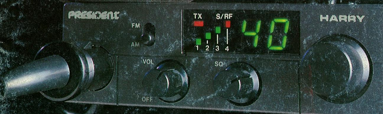
Ricetrasmittitore CB 27 MHz AM/FM 40 ch
