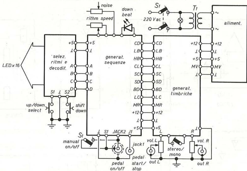
figura 6 - Schema a blocchi e cablaggi.
