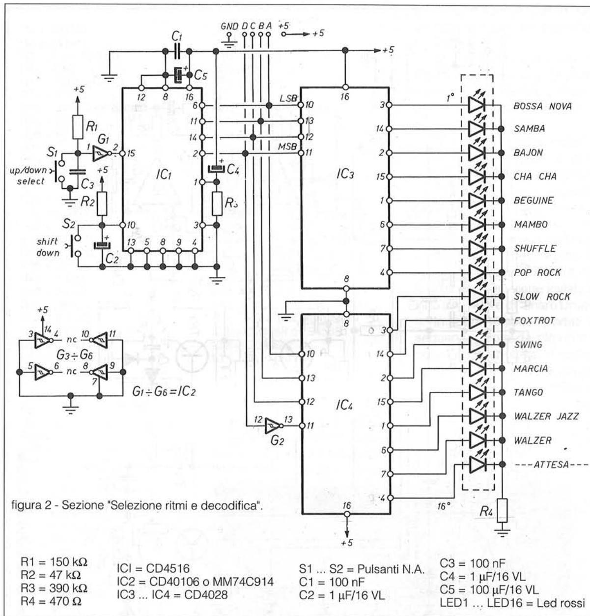
Le sigle che ho riportato su queste uscite ci indicano il tipo di strumento che, tramite il Generatore di Timbriche, verrà simulato.
