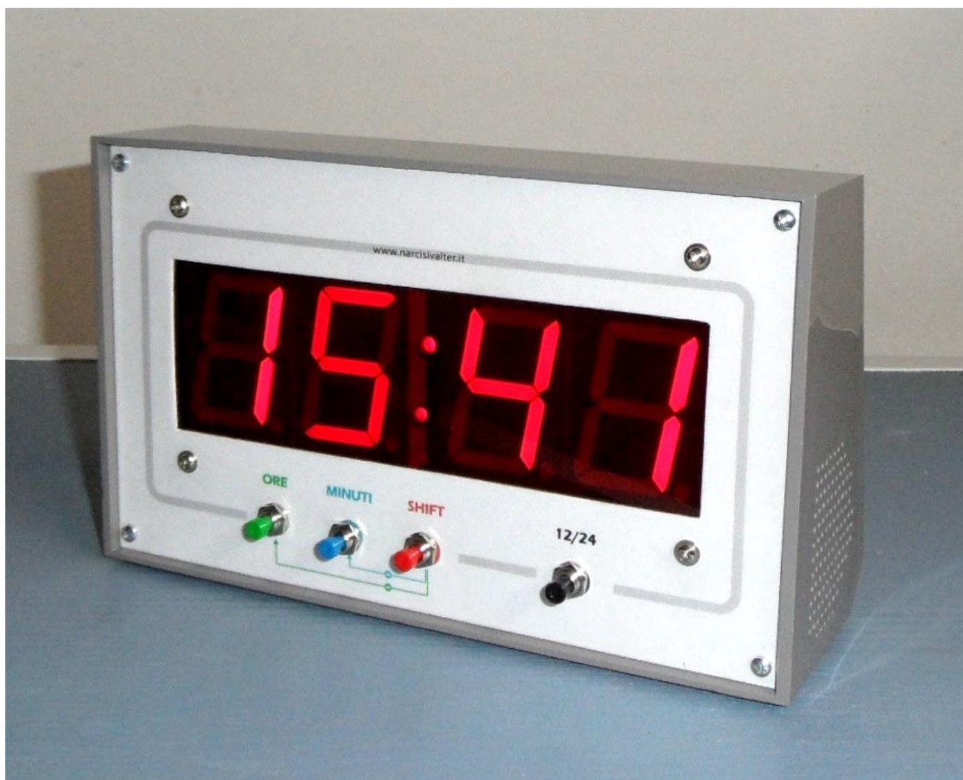
*Realizzazione di un preciso orologio digitale HH:MM con display giganti (utilizzando il PIC16F886)*
