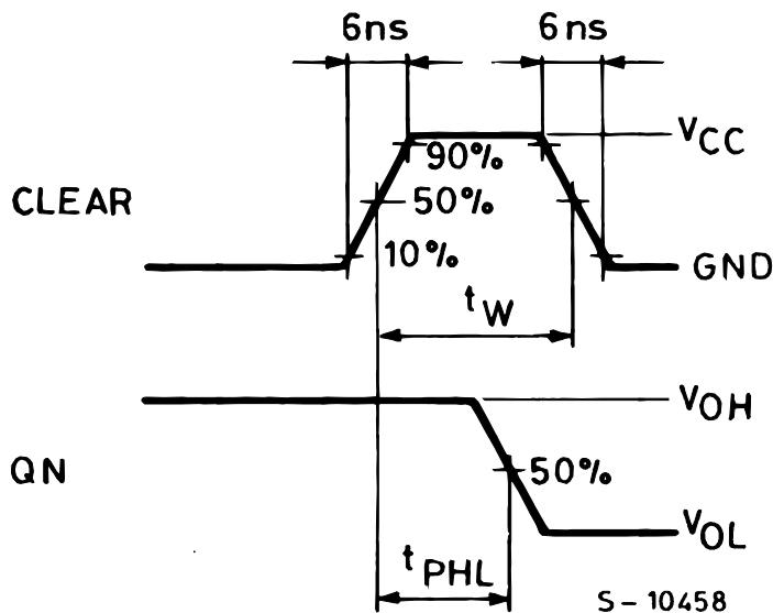
**WAVEFORM 3 :PROPAGATION DELAY TIMES (f=1MHz; 50% duty cycle)**
