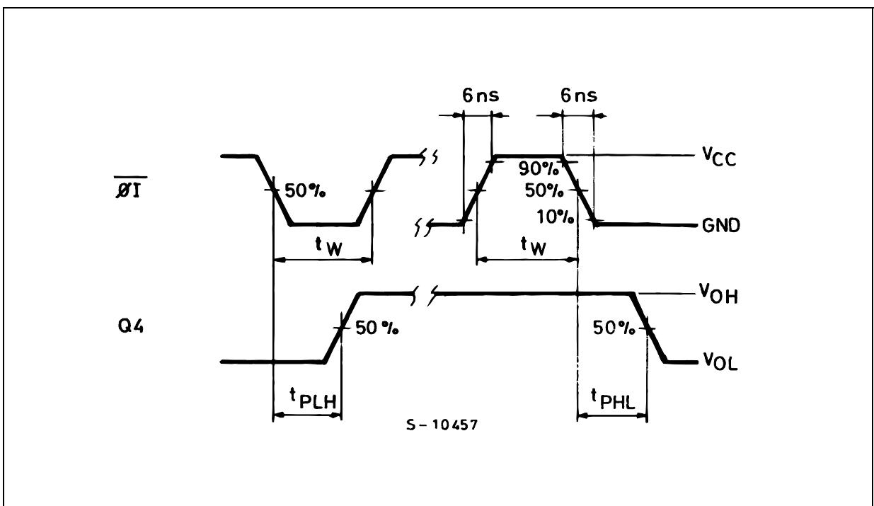
**WAVEFORM 2 : PROPAGATION DELAY TIMES, MINIMUM PULSE WIDTH (CLEAR) (f=1MHz; 50% duty cycle)**
