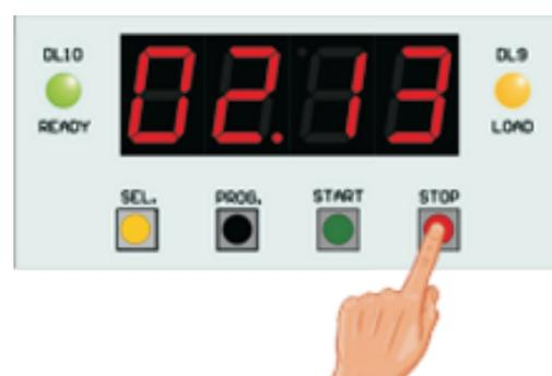
In questa situazione, premendo il pulsante **START** il Timer si riavvia dal punto in cui era stato interrotto mentre premendo ancora una volta il pulsante **STOP**, il conteggio si arresta definitivamente (TERMINA) e il Timer è pronto per essere nuovamente avviato dall'utente (**LED verde** acceso).
