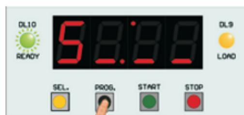
Premere una o più volte il pulsante ► (**START**) per selezionare la posizione del display in cui inserire il valore da programmare.
